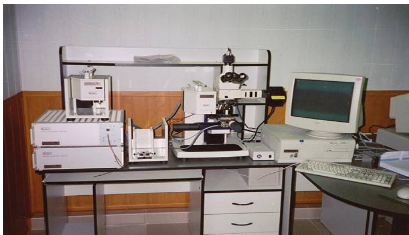
Рис. 1. Внешний вид нанотвердомера NHT-S-AX-000X
