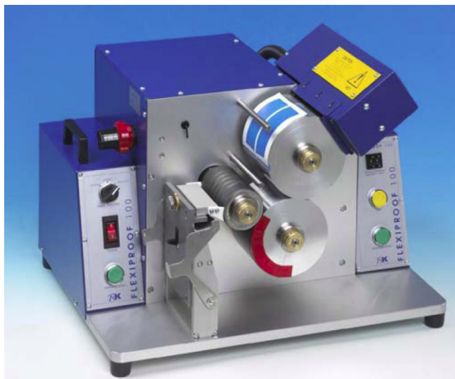
Рис. 1. Флексографское пробопечатное устройство Flexiproof 100 UV
