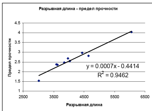
Рис. 2. Связь разрывной длины и предела прочности
